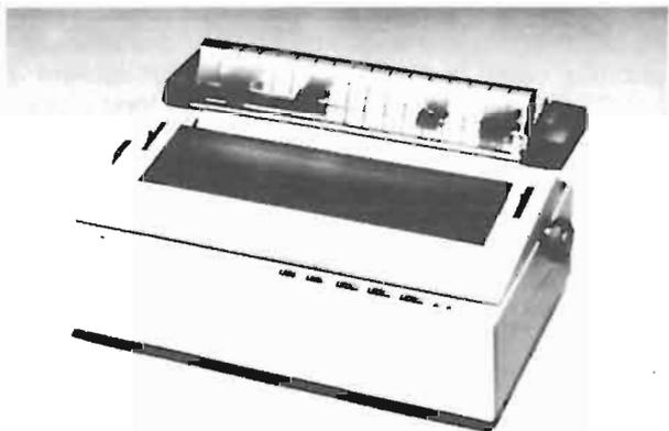
Fig. 6 - Una delle più prestigiose scriventi Olivetti: la DY 211. La scrittura avviene mediante «margherita»; il rullo ha la lunghezza utile di 40 cm; 4 passi di stampa.
