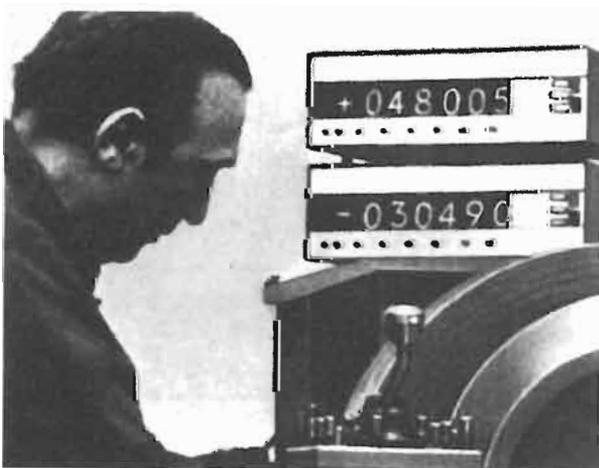
Fig. 12/12 - Indicazione numerica di posizione in un tornio a motore per facilitare le operazioni di misura e regolazione.
